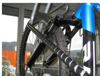
Ce système de protection de la peinture protège le cadre et la fourche contre les rayures
